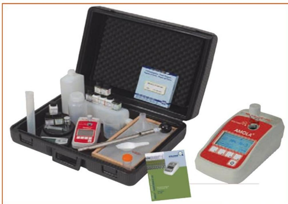
***Рисунок 11. Удобный (передвижной) прибор, определяющий количество питательных веществ в почве в полевых условиях.***
