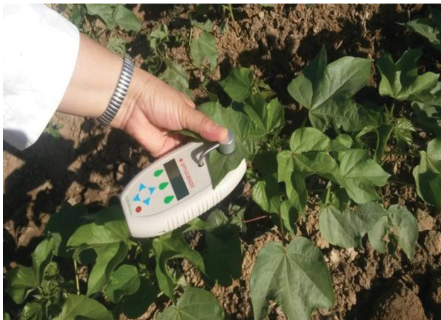
Рисунок 2. Определение количества хлорофилла в листе хлопка с помощью CCM 200 plus
